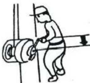
Рисунок 7. Высота установки лебедки.
