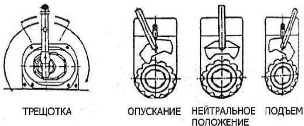
Рисунок 13. Положения работы трещотки лебедки
